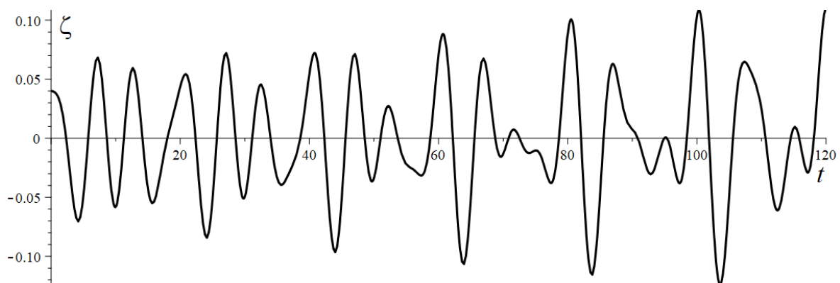
Рисунок 4.4: Рівень підйому вільної поверхні за умови що \omega_h = \omega_v = 1.28 Гц.
