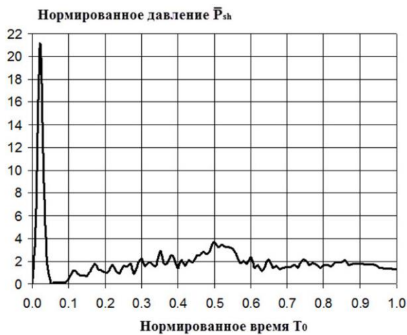
Рис. 2. Распределение давления в точке торможения при ударе мягкого тела о жесткую преграду
