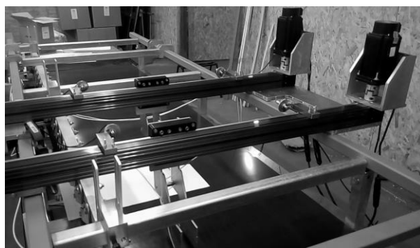
Рис. 5. Конвеєрний стіл автоматизованої системи в цеху підприємства
