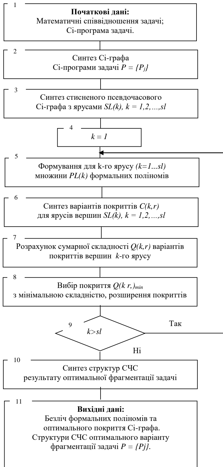
Рис.4. Модель фрагментації задач із застосуванням структур СЧС та формальних поліномів.
