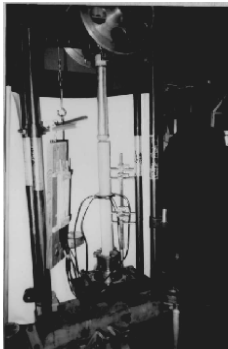
Рис. 1. Схема исследования и общий вид стенда с моделью при исследовании несущей способности системы АК. 1 – АВФ, 2 – модель БК, 3 модель ББК, 4 – отломок латерального мыщелка ББК, 5 – датчик БСРН, 6 – компрессионная гайка, 7 – панель с монометром, 8 – линия перелома
