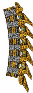
Рис. 1. Конечно-элементные модели системы «грудной отдел позвоночника - имплантат»: а) - первый вариант фиксации; б) - второй вариант фиксации
