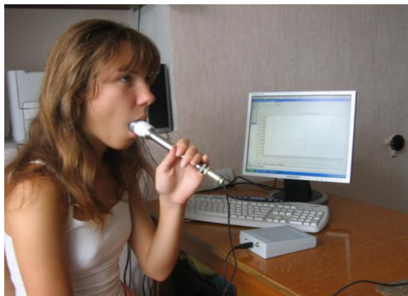
Рис. 1. Проведення експерименту з дослідження видихуваного газу хворого за допомогою сенсорів
