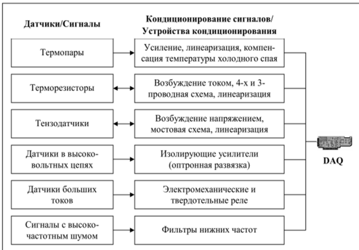
Рис. 1. Типы датчиков и сигналов для подключения к персональному компьютеру с помощью аппаратного модуля DAQ [5]
