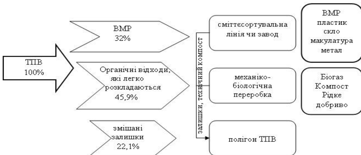
Рис. 4 – Схема розподілу потоку твердих побутових відходів та отримання сировини і продуктів переробки за умови відділення «вологої фракції» відходів
