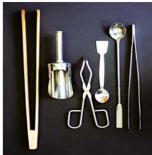
Рис. 4 – Інструменти для відбору проб (зліва направо): щипці великі, лопатка, кліщі тигельні, ложка-шпатель маленька, ложка-шпатель велика, пінцет
