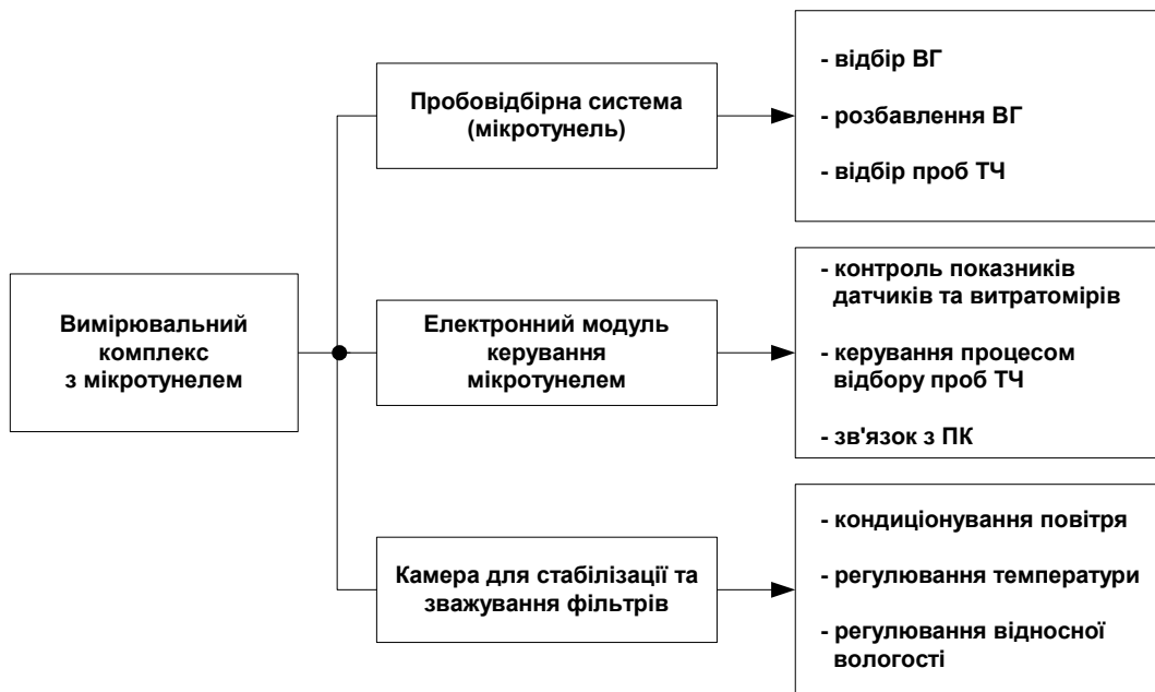
Рис. 5 – Елементи вимірювального комплексу з МКТ-2 та функції, які вони виконують
