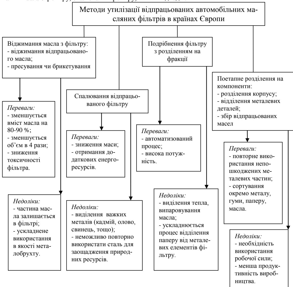
Рис. 1 – Методи утилізації відпрацьованих автомобільних масляних фільтрів
