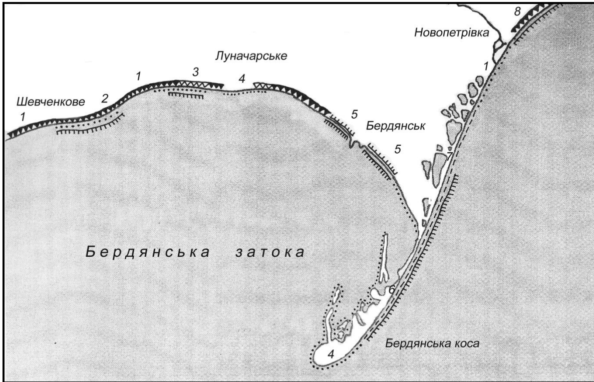
Рис. 4. Структура берегової зони Бердянського літодинамічного вузла (масштаб 1 см – 2,3 км), цифрами на схемі позначені наступні ділянки: 1 – абразійні; 2 – абразійно-акумулятивні з певними берегозахисними спорудами; 3 – акумулятивно-абразійні з певними берегозахисними спорудами; 4 – акумулятивні; 5 – техногенні; 6 – акумулятивні, що розмиваються, з певними берегозахисними спорудами; 7 – акумулятивні, які розмиваються; 8 – абразійні з берегозахисними спорудами [10]
