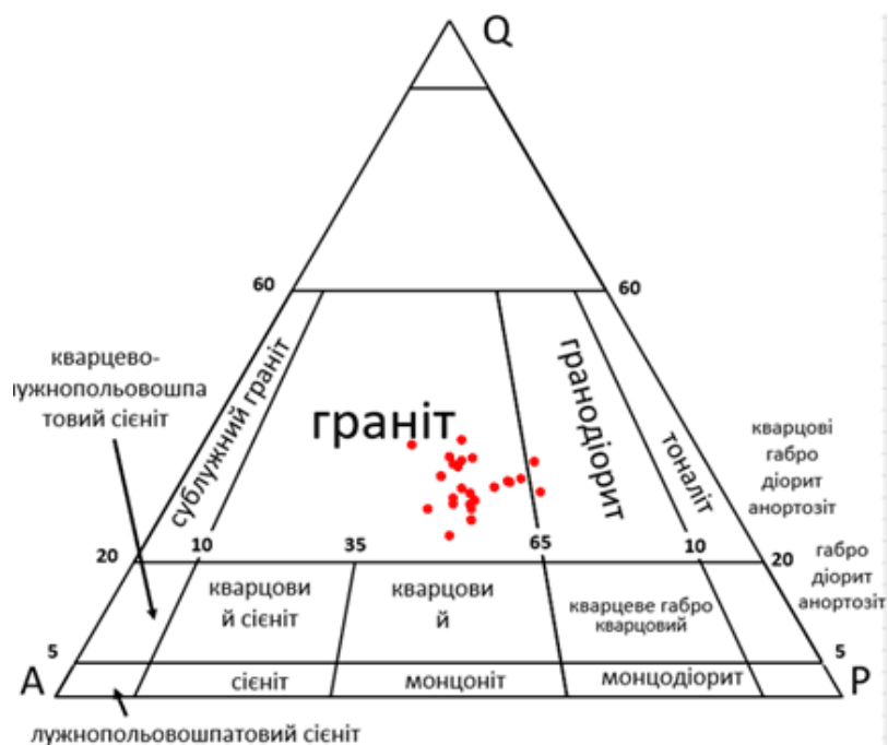
Рис. 4. QAPF-діаграма [27] з результатами петрографічного аналізу порід Мокромосковського масиву / Fig. 4. QAPF diagram [19] with the results of petrographic analysis of Mokromoskovsk pluton rocks
