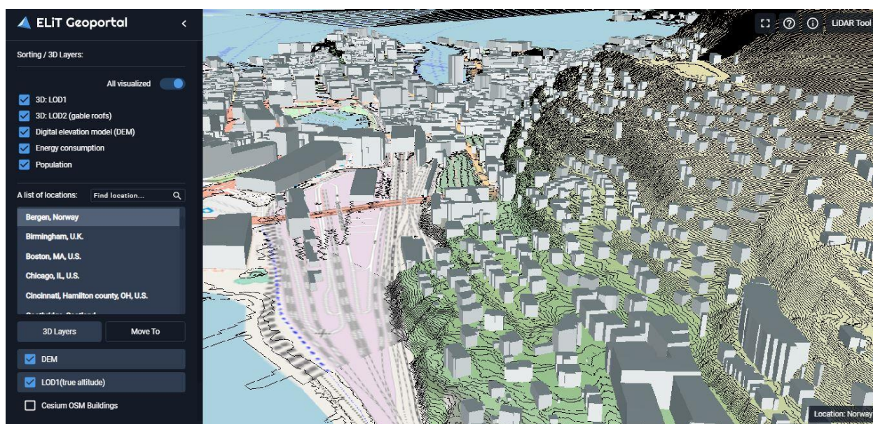
Рис. 7. ЦМР, побудована в середовищі веб-ГІС ELiT, для оцінки ризиків повеней / Fig. 7. DEM built in the ELiT web-GIS environment for flood risk assessment
