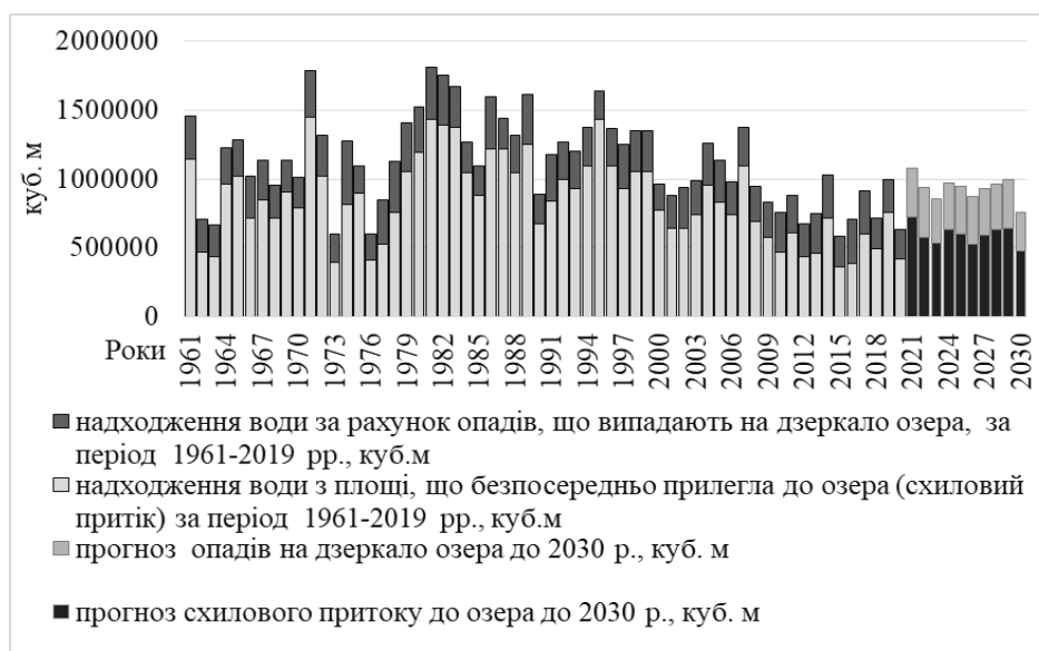
Рис. 3. Динаміка сумарного надходження води до оз. Лебедине (з площі прилеглої до озера та атмосферних опадів на дзеркало озера) за період з 1961 по 2019 рр. та його прогнозні оцінки на період з 2021 по 2030 рр. /
