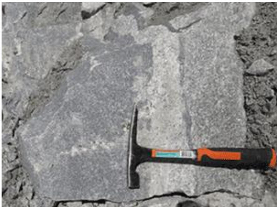
Рис. 10. Азональна біотитвмісна пегматитова жила в Основному кар'єрі Янцівського родовища в с. Кам'яне / Fig. 10. Azonal biotite-bearing pegmatite vein in the Main quarry of the Yantsiv deposit in Kam'yane village
