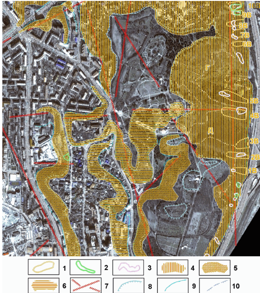
Рис. 1. Картографічна модель розповсюдження та динаміки зсувів з отриманими шарами ГІС (фрагмент) [3]. Зсувні ділянки: 1 – контури зсуву скориговані, за космічними даними; 2 – активні зсувні ділянки; 3 – зони підвищеної зсувної небезпечності; зони підвищеного зсувного ризику: 4 – небезпечна; 5 – помірно небезпечний; 6 – малонебезпечний; 7 – зони геодинамічного напруження (лінеаментів), виявлені за результатами інтерпретації матеріалів космічного зображення та частково підтверджені геологічними даними; горизонтальна структура рельєфу: 8 – верхня кромка схилу; 9 – нижня кромка скату; 10 – вигин схилу /
