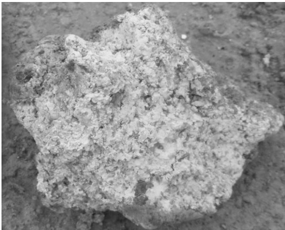
Рис. 4. Первинні каоліни (проба П-2) з успадкованою текстурою та структурою докембрійських плагіогранітів (а), б- частково перевідкладені первинно-вторинні каолінові глини (проба П-8)
