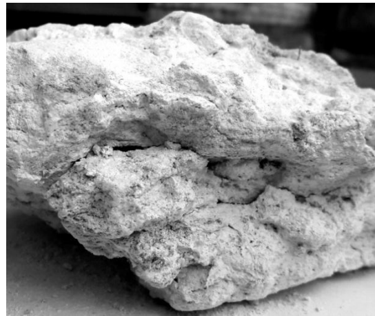
Рис. 4. Первинні каоліни (проба П-2) з успадкованою текстурою та структурою докембрійських плагіогранітів (а), б- частково перевідкладені первинно-вторинні каолінові глини (проба П-8)
