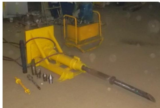
Рис. 7 – Експериментальна установка для проколу ґрунту
