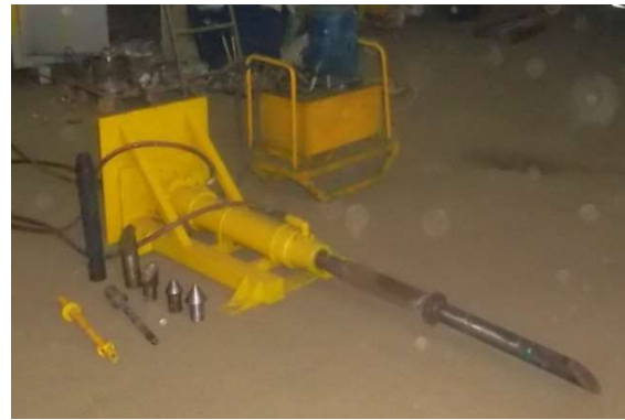
Рис. 7 – Експериментальна установка для проколу ґрунту
