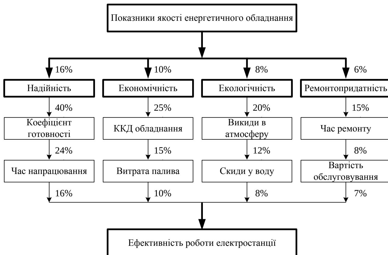
Рис. 2 – Структура показників якості енергетичного обладнання та їх вплив на ефективність роботи електростанції
