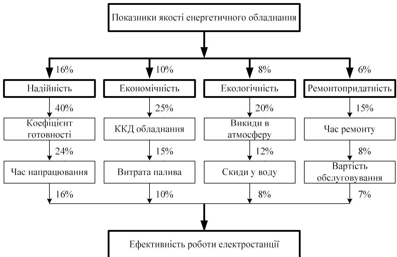
Рис. 2 – Структура показників якості енергетичного обладнання та їх вплив на ефективність роботи електростанції
