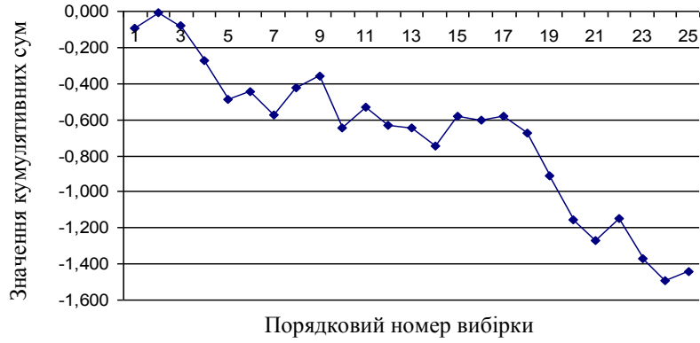
Рис. 1 – Вигляд кривої кумулятивних сум при обробці \varnothing 55_{-0,46} Fig. 1 – View of the cumulative sums curve during machining \varnothing 55_{-0,46}
