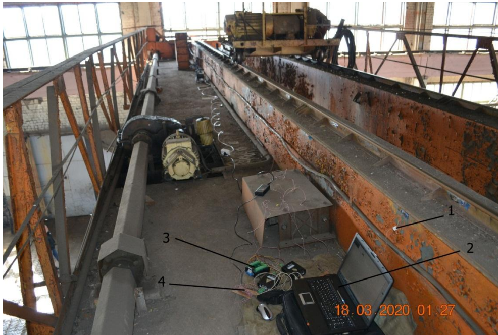
Рис. 2 – Загальний вигляд вимірювального обладнання: 1 – клемна колодка; 2 – ЕОМ;
