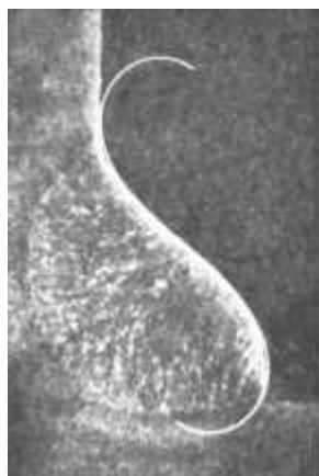
Рис. 1 -Сравнение реальной и теоретической формы углового шва
