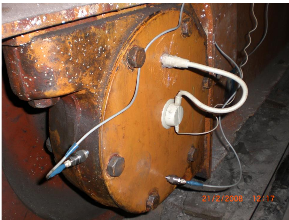
Рис. 1 – Установка датчиков регистрации шума и вибрации на буксу ходового колеса мостового крана.
