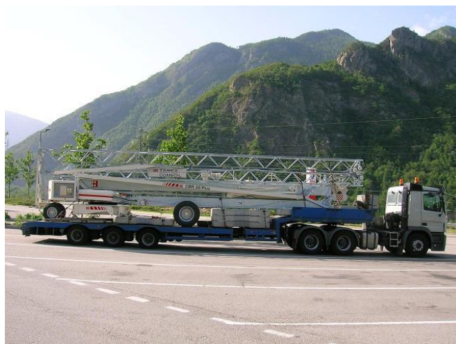
Рис. 7 – Перевозка быстромонтируемого башенного крана фирмы Comedil
