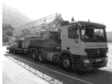
Рис. 2 - Перевозка быстромонтируемого башенного крана на одной машине
