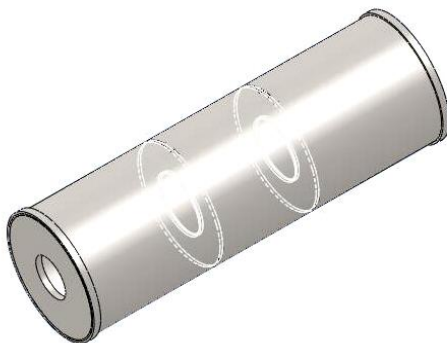
Рис. 2 – Барабаны с подкрепляющими с кольцами
