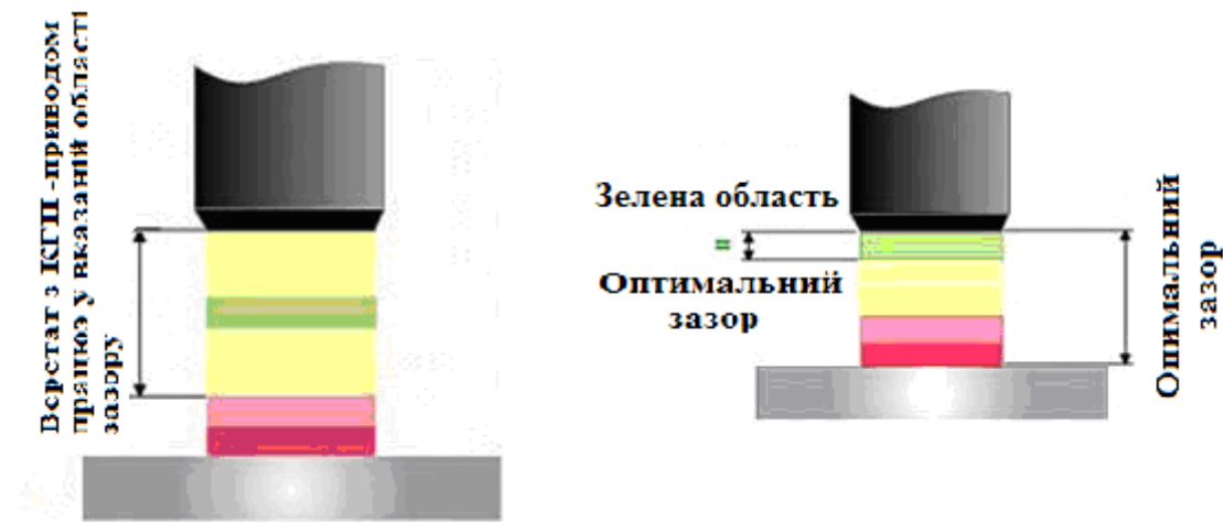
Рис. 1 – Схема порівняння зазорів між електродом та заготовкою в ЕФО-процесі по даним фірми «Sodick»
