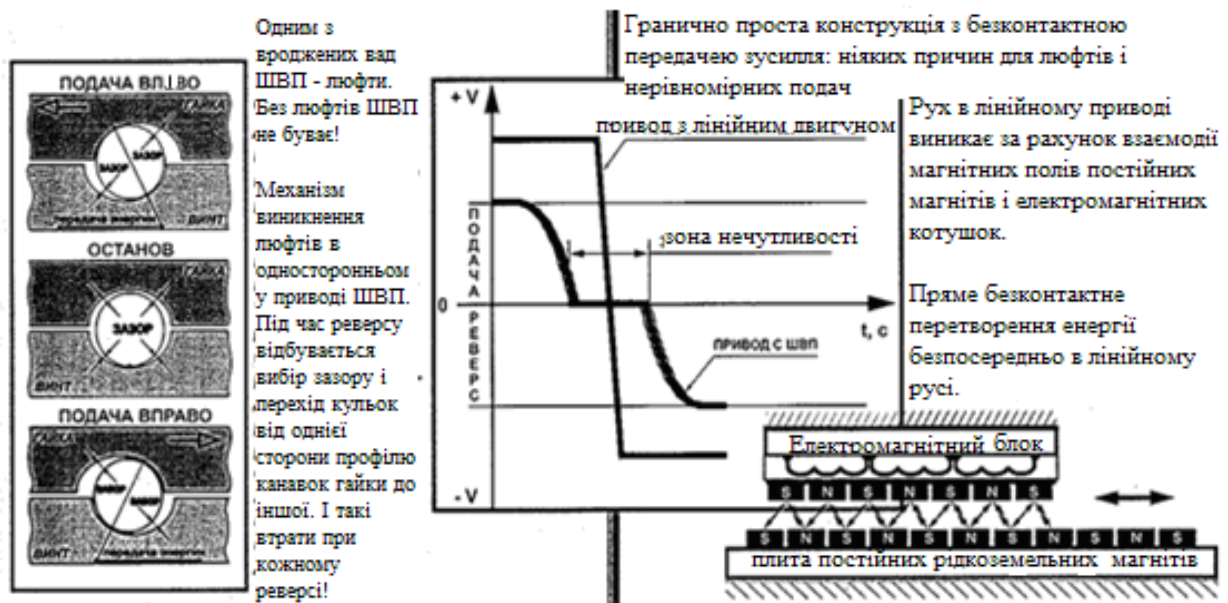
Рис. 3 – Порівняльна характеристика приводів з КГП та лінійного
