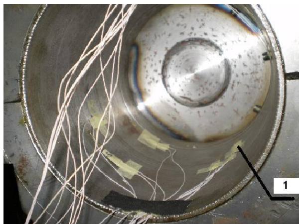
Рис. 2 – Канатный барабан (расположение измерительных тензорезисторов)
