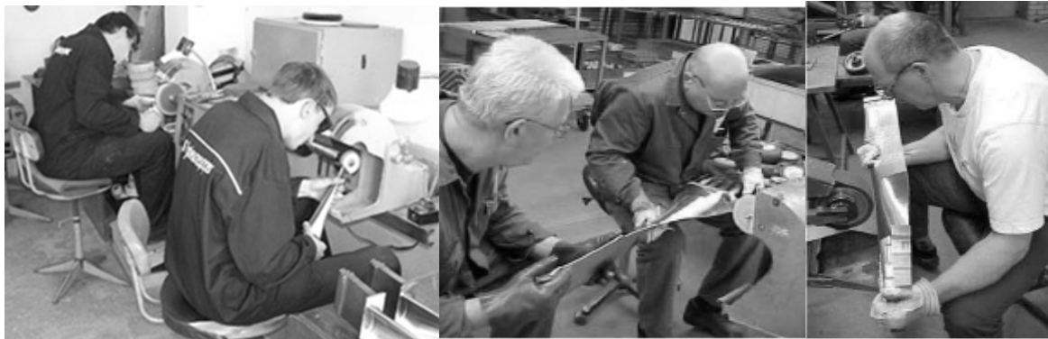
Рис. 2 – Ручной способ шлифования лопаток
