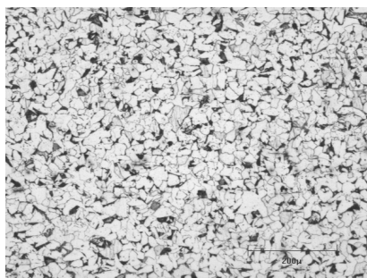
Фото 1 – Металлографические снимки образцов отобранных для исследований (8 бал зерна)
