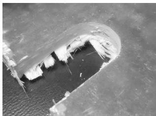
Рис. 6 – Якість поверхні торця та кромки зрізу при розрізанні кінцевою фрезою виробу листової форми із ВПК: а – при зустрічному; б – побіжному різанні
