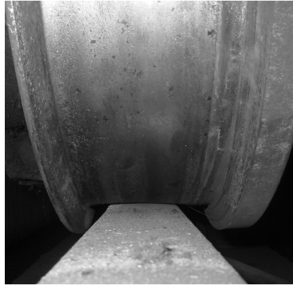
Рис. 1 – Знос реборд ходового колеса
