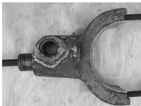
Рис. 2 – Приклади ремонтного зварювання чавунних деталей
