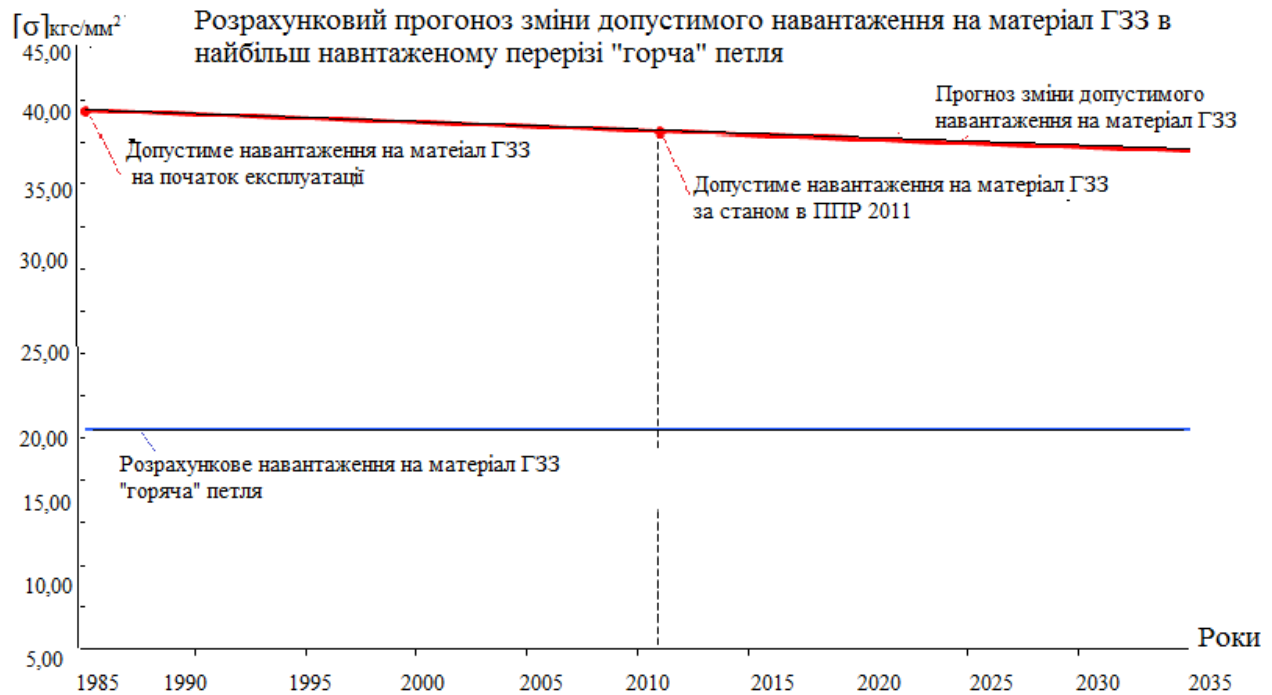
Рис. 4 – Розрахунковий прогност змiни допустимого навантаження матерiал ГЗЗ в найбільш навантаженому перерiзi «горяча» петля
