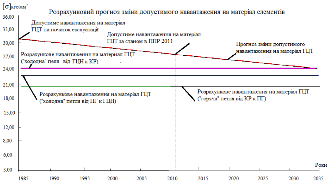
Рис. 3 – Розрахунковий прогноз зміни допустимого навантаження на матеріал елементів ГЦТ
