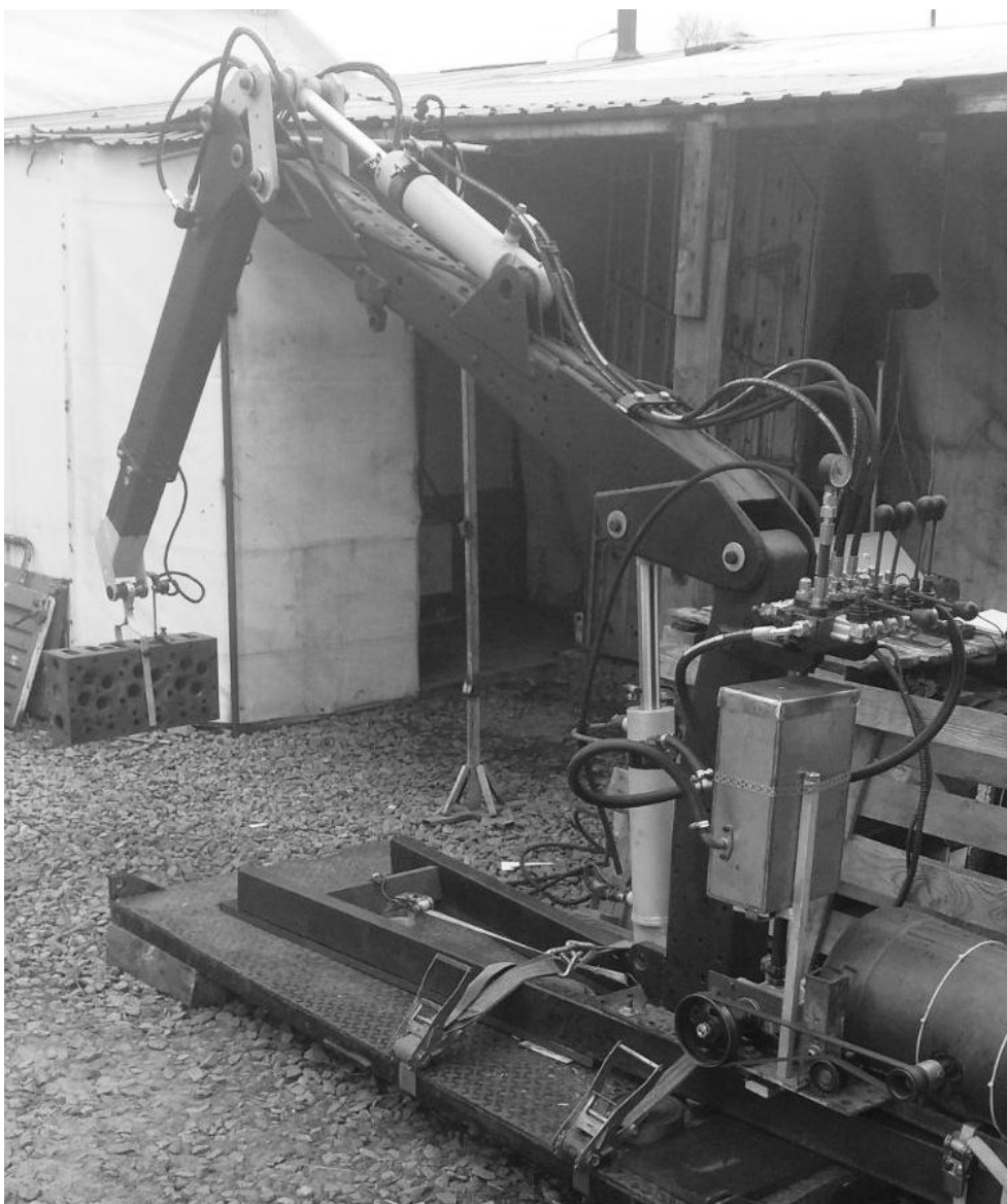
Рис. 1 – Розроблена експериментальна установка крана-маніпулятора з гідравлічним приводом
