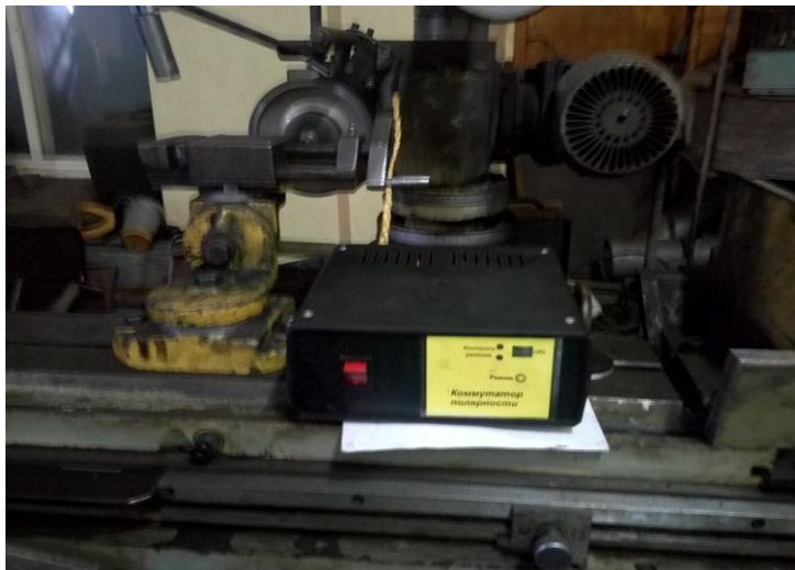
Рис. 1 – Процес електроерозійного шліфування зі змінною полярністю електродів.
