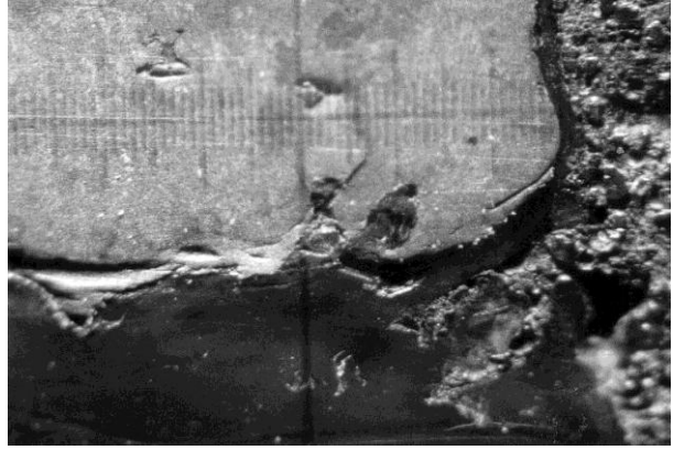
Рис.4 – Макроструктура металу кінця електрода з покриттям що містить 0,35% графіту: х 27
