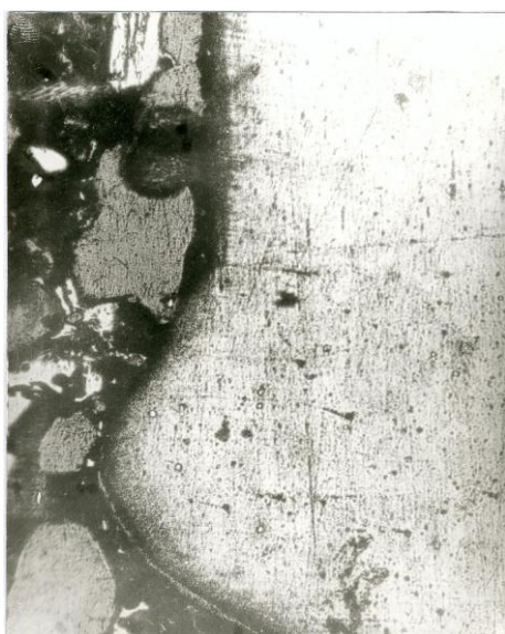
Рис.1 – Мікроструктура металу кінця електрода з покриттям що містить 10% чавунного порошку: x 120
