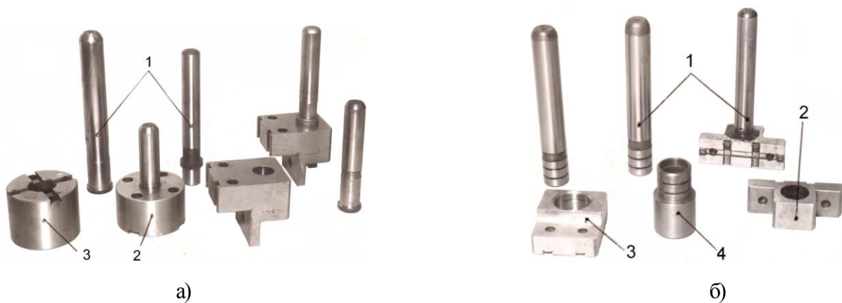
Рис. 1 - Направляючі елементи: а – УСШ-16; б – УСШ-8: 1 – направляюча колонка; 2 – нижня обойма; 3 – верхня обойма; 4 – направляюча втулка
