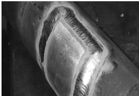
Рис.2 – Зовнішній вигляд зварного з'єднання
