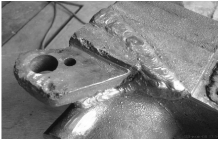
Рис. 3 – Вигляд чавунних деталей після зварювання
