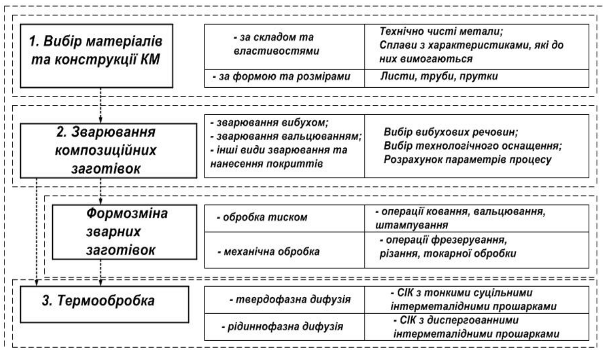
Рис. 10 – Схема комплексного технологічного процесу виготовлення титано-алюмінієвих шаруватих інтерметалідних композитів
