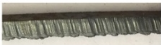
Рис. 2 – Зовнішній вигляд зразків вирізаних зі сталі 20 (а) та нержавіючої сталі (б) марки 12X18H10T
