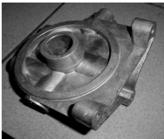
Рис.1 - Литая заготовка и модель детали «Корпус адсорбера».
