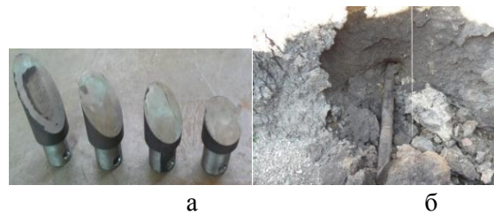
Рис. 8 – Перевірка величини відхилення головки від проектного напрямку: а – експериментальні наконечники; б – відхилення головки на виході Fig. 8 – Checking the magnitude of the head deviation from the design direction: а – experimental tips; б – head deviation at the exit
