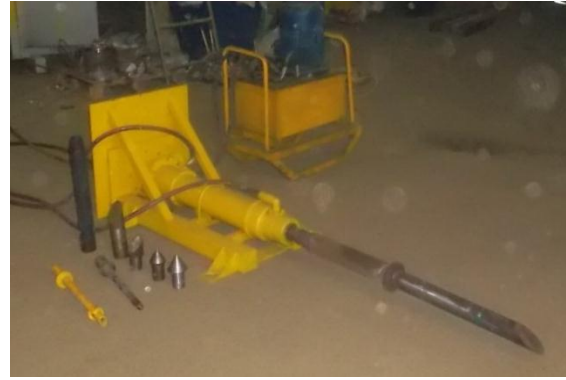
Рис. 7 – Експериментальна установка для проколу ґрунту Fig. 7 – Experimental setup for soil puncture
