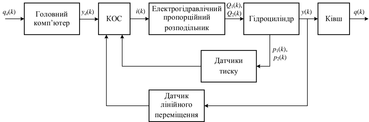
Рис. 2 – Структура системи керування ковшем навантажувача Fig. 2 – Control system structure of a wheel loader bucket
