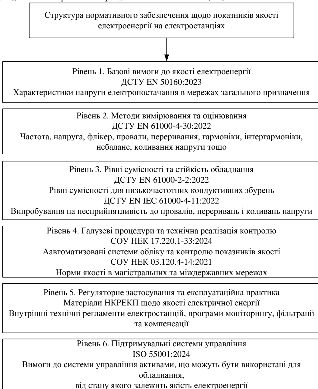
Рис. 1 – Структура нормативної бази України щодо підвищення показників якості електроенергії Fig. 1 – Structure of the regulatory framework of Ukraine for improving electricity quality indicators
