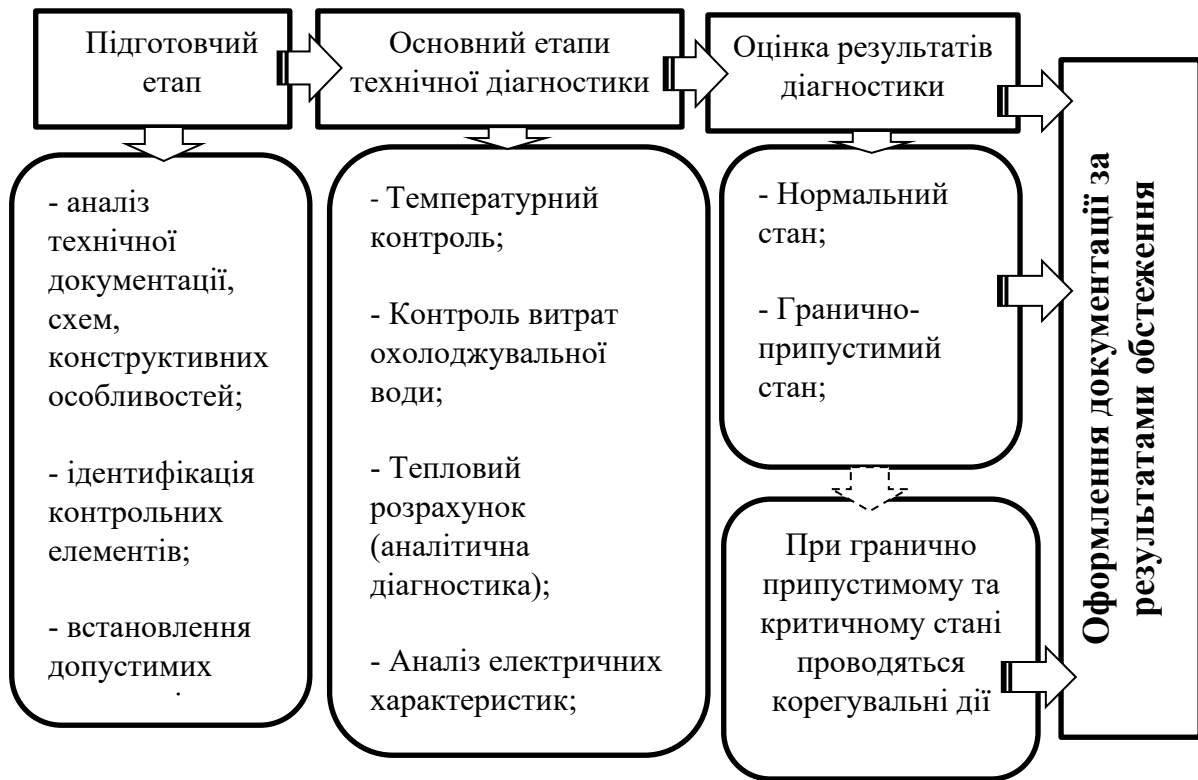
Рис. 1 – Візуалізація етапів технічної діагностики стрижнів обмотки статора турбогенератора Fig. 1 – Visualization of the stages of technical diagnostics of the stator winding rods of a turbogenerator
