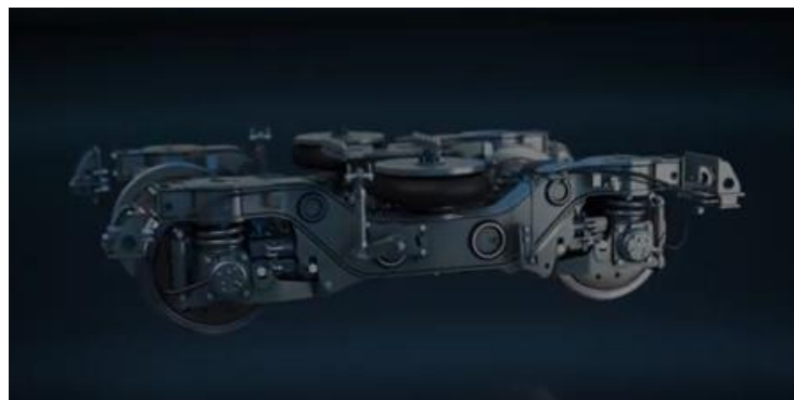
Рис. 8 – Візок із несучою рамою з вуглецевого волокна. Fig. 8 - The bogie has a carbon fibre support frame.
