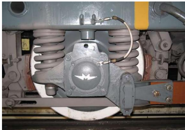
Рис. 4 – Буксове підвішування шпінтонного візка.
