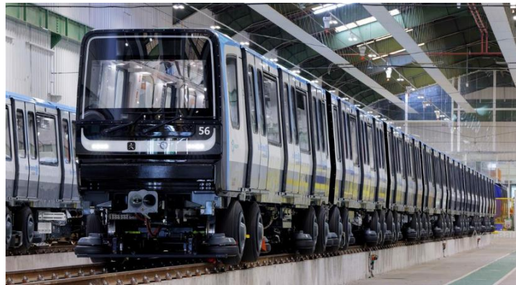
Рис. 10 – Рухомий склад Паризького метрополітену на шинному ході. Fig. 10 - Rolling stock of the Paris Metro on tyres.
