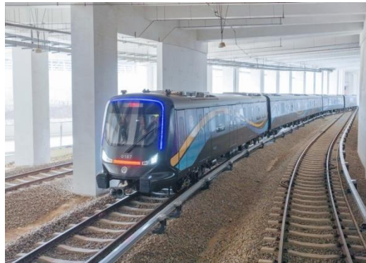
Рис. 7 – Поїзд метро з вуглецевого волокна CETROVO 1.0. Fig. 7 - The CETROVO 1.0 carbon fibre subway train.
