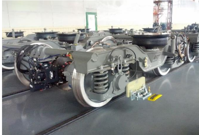
Рис. 5 - Візок моторний моделі 68-7054 з пневмопідвішуванням та дисковими гальмами. Fig. 5 - Motor bogie model 68-7054 with pneumatic suspension and disc brakes.
