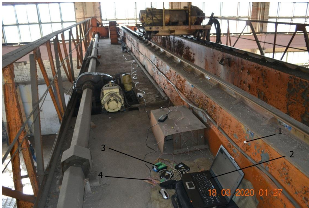
Рис. 2 – Загальний вигляд вимірювального обладнання: 1 – клемна колодка; 2 – ЕОМ; 3 – АЦП; 4 – напівмостова схема підключення
