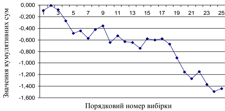
Рис. 1 – Вигляд кривої кумулятивних сум при обробці \text{Ø } 55_{-0,46} Fig. 1 – View of the cumulative sums curve during machining \text{Ø } 55_{-0,46}
