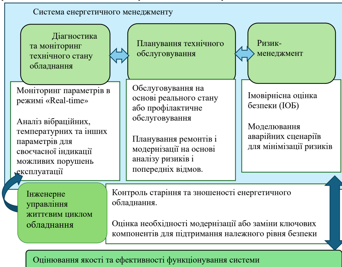
Рис.1- Модель інжинірингового управління енергетичним обладнанням Fig. 1- Model of engineering management of power equipment
