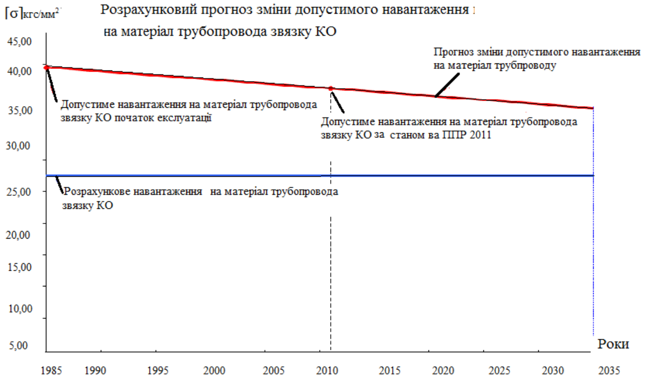
Рис. 5 – Розрахунковий прогност змiни допустимого навантаження на матерiал трубопровода зв'язку КО з «горячої» ниткою петлі №4 ГЦК
