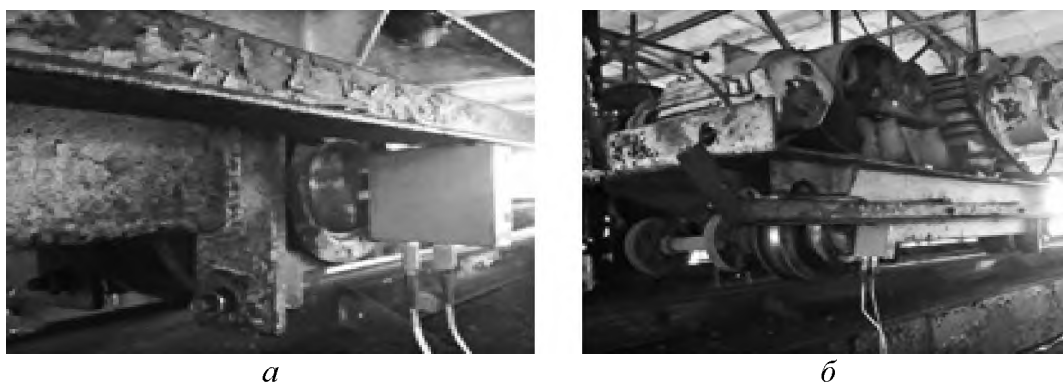
Рис. 3. Розміщення датчиків прискорень на осі коліс візка: а – ведене колесо; б – привідне колесо
