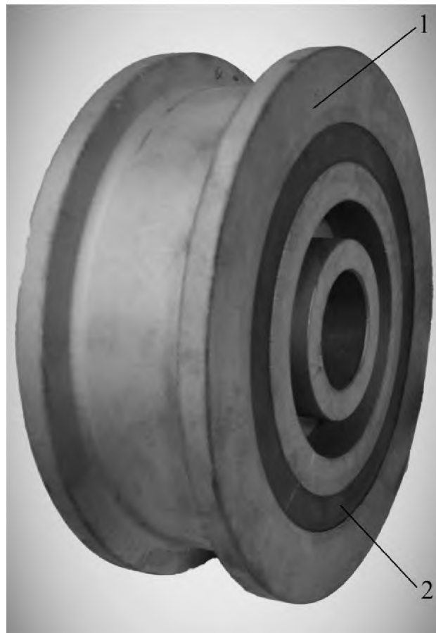
Рис. 1. Конструкція кранового ходового колеса з еластичною вставкою 1 – зовнішній шар з міцного матеріалу, 2 – середній шар з легкого наповнювача.
