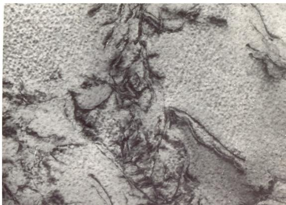
Рис. 6. Зоны Гинье-Престона в закаленных эвтектических сплавах. Увеличение  $\times 50000$
