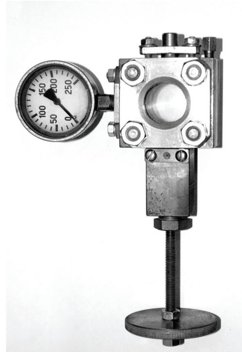
Рис. 2. Внешний вид ячейки высокого давления.
