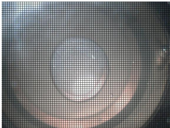
Рис. 3. Вода при атмосферном давлении (в начале фазы сжатия). Для сравнительного определения объема газа на этом рисунке и ниже нанесена градуировочная сетка с размером ячейки 0,4 мм.
