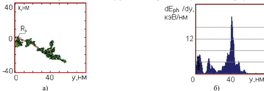
Рис.5. Многосвязный каскад, образующийся при взаимодействии иона Xe<sup>+</sup> с атомами золотой поликристаллической мишени (а); продольное распределение фоновых потерь иона в материале мишени (б). Энергия иона  $E = 400$  кэВ,  $L \sim 42$  нм.
