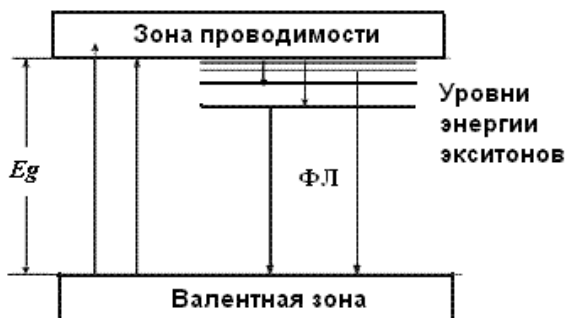
Рис. 5. Схематическая диаграмма полосы экситонной фотолюминесценции наночастиц ZnO
