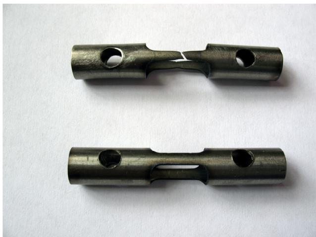
Рис.1 Образцы (верхний – после испытаний, нижний – до испытаний).
