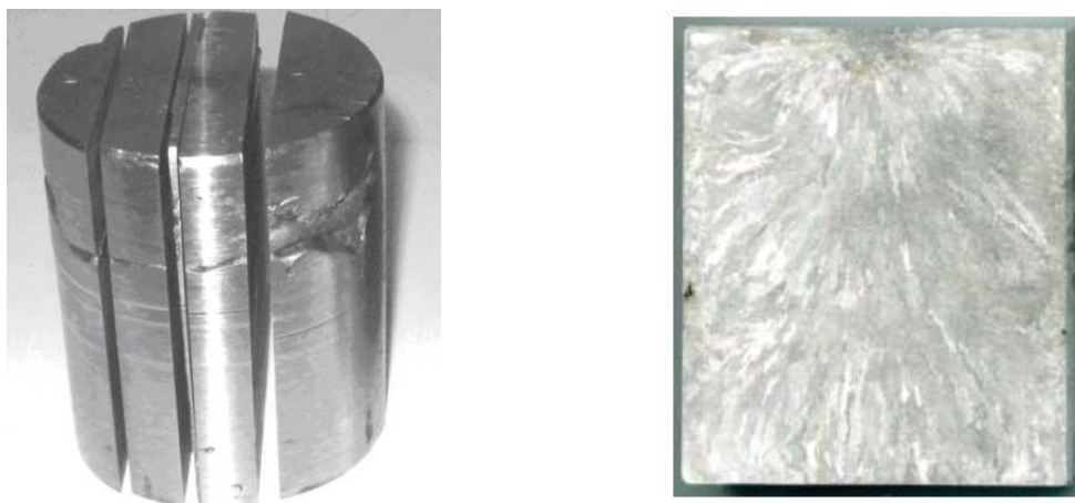
Рис. 2. Разрезанный слиток 08X18H10T с 0,02 вес. % ZrO_2 + Y_2O_3 . (слева), макроструктура центрального темплетта слитка (справа).
